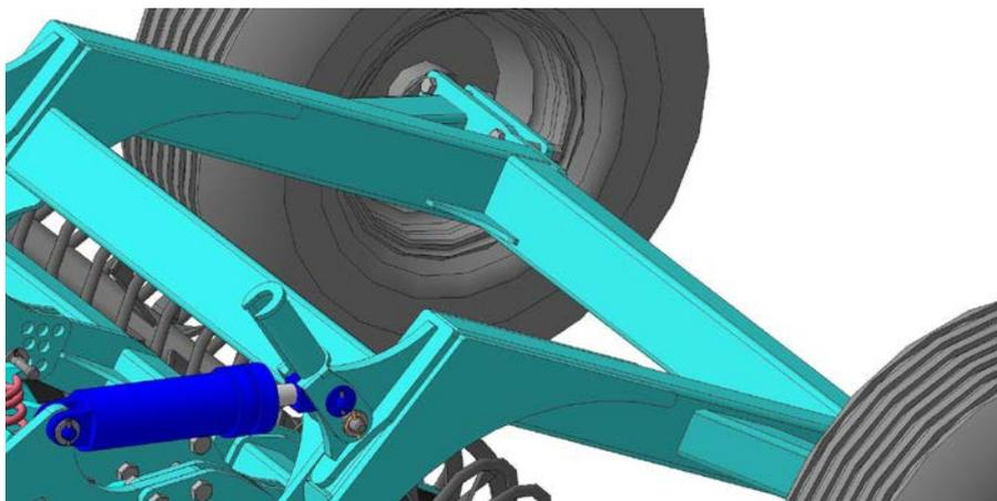
**Прутковый каток диаметром 500мм из прута 30мм
