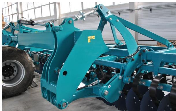
Секции закреплены на трехточечной навеске, которая позволяет копировать каждой секции в поперечном направлении, что улучшает копирование почвы и снижает нагрузку на раму. Навеска в работе находится в плавающем положении, что обеспечивает продольное копирование рельефа каждой секцией отдельно.
