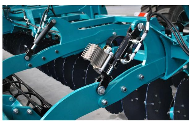
Регулировка глубины обработки осуществляется с помощью клипс, расположенных на штоках гидроцилиндров. Это позволяет удобно и быстро настроить агрегат на необходимую глубину.
