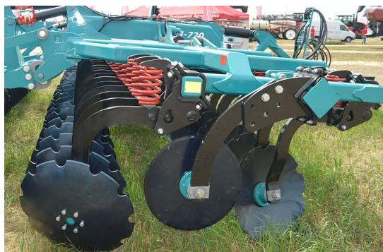
**Рабочий орган:** необслуживаемый пружинный блок, стойка из качественной легированной конструкционной высокоуглеродистой стали, необслуживаемый режущий узел, диск диаметром 610 мм.
