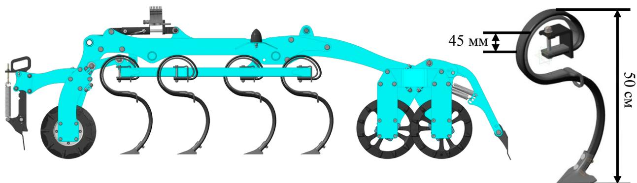
Рис. 7 Четырехрядная секция
