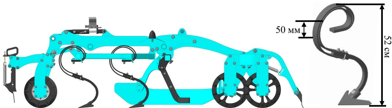
Рис. 6 Двухрядная секция
