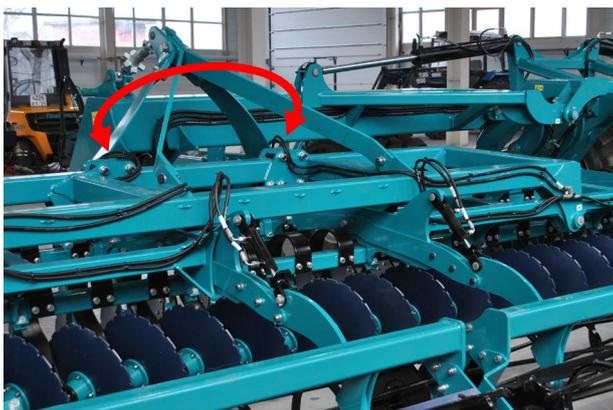
Система поперечного копирования подрамников секций, позволяет снизить нагрузку на секцию при работе по неровным полям и улучшает копирование почвы всем агрегатом.
